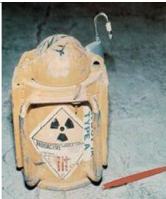
27. Töltésszint mérő sugárforrás tartó (Co-60 / Cs-137) b
