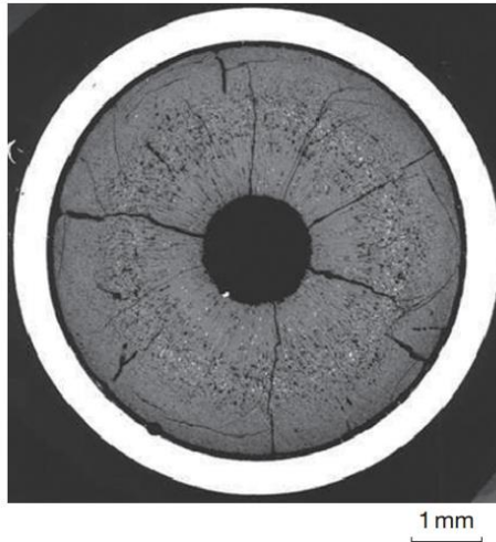
Phénix gyorsreaktoros, eredetileg tömör tabletta besugárzás után
